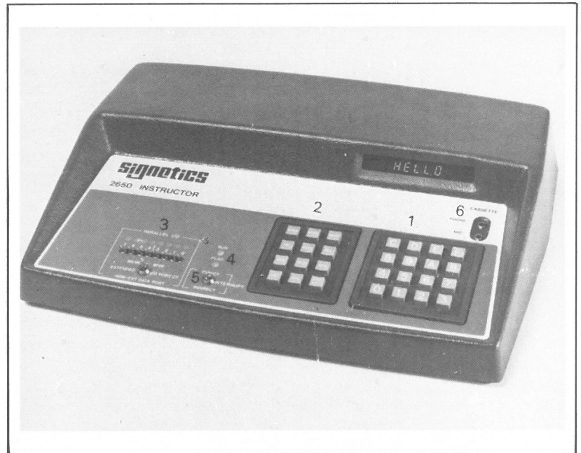
Le pupitre de dialogue : clavier d'entrée des données (1) ; touches de fonctions (2) ; 8 commutateurs d'entrée/sortie (3) ; voyants de visualisation RUN et FLAG (4) ; un commutateur « INTERRUPT » (5) ; prises de raccordement cassette (6), et un affichage digital à 8 digits.
