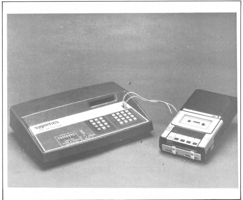
Le micro-ordinateur « Instructeur 50 » est conçu autour d'un microprocesseur 2650 de Signetics. Le magnétophone à cassette sur lequel il est possible de recopier des programmes est du type « audio ».
