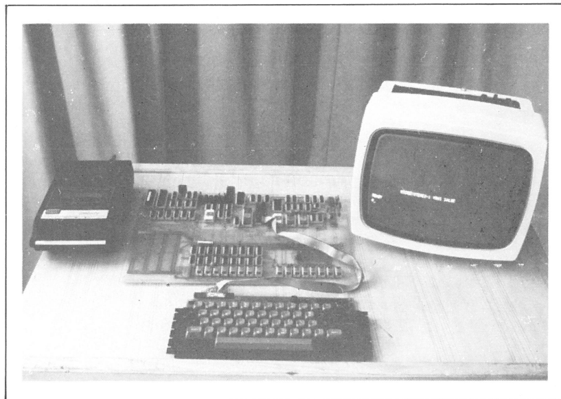
Un circuit imprimé de 42 x 27,5 cm supporte les quelques 88 circuits intégrés de « Micro-Systèmes I ».
